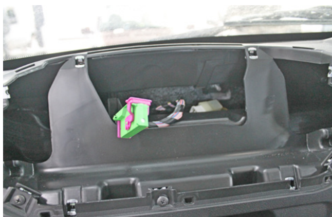
Фото 1.5. Панель приборов снята
