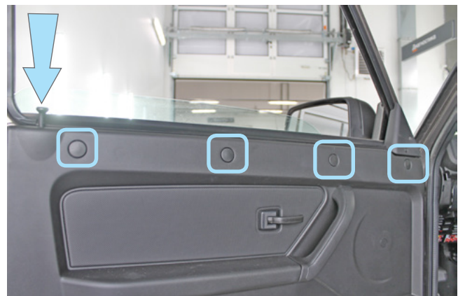
Фото 1.19. Пластиковая кнопка блокировки замка двери и заглушки
