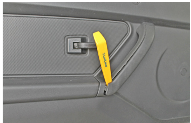
Фото 1.21. Снять пластиковую накладку ручки двери
