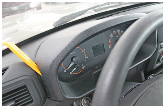
Фото 1.2. Снять декоративную накладку панели приборов
