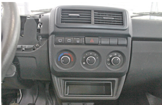
Фото 1.6. Блок управления отопителем. Общий вид
