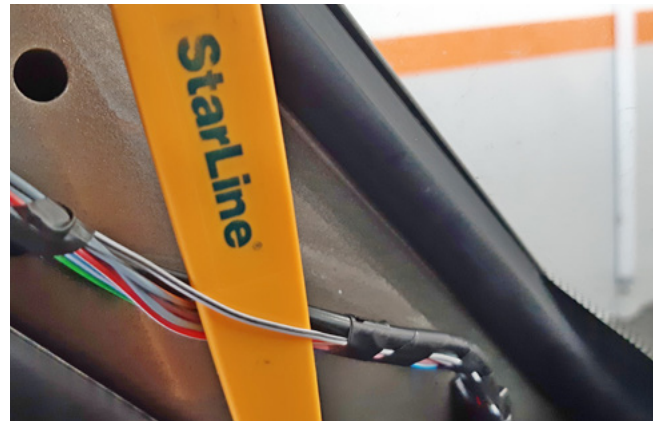
Фото 3.5. Контроль концевиков дверей (бело-чёрный)
