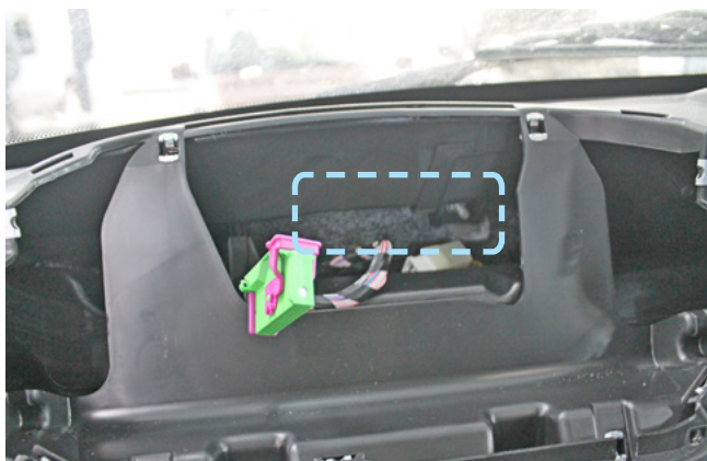
Фото 2.10. Пример расположения центрального блока охранно-телематического комплекса
