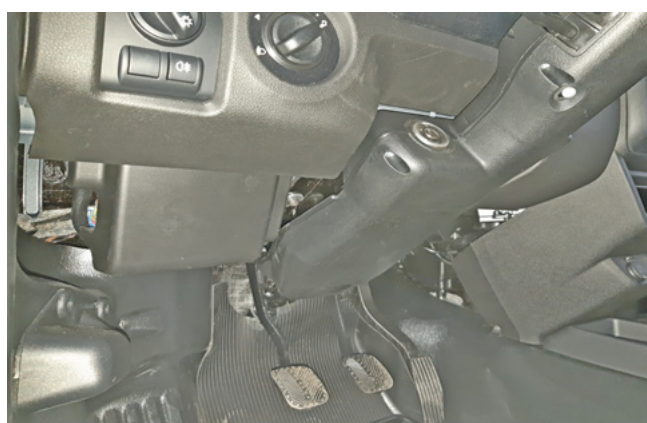
Фото 1.14. Кожух рулевого вала. Общий вид
