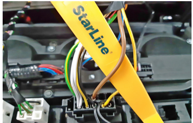
Фото 3.7. Управление световыми сигналами (коричневый)
