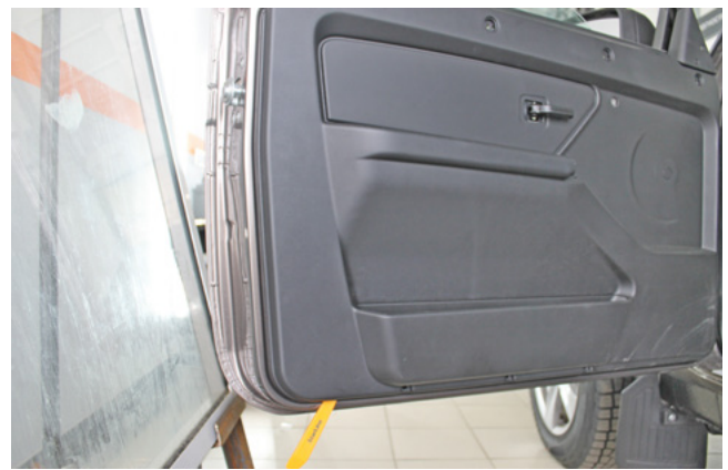
Фото 1.25. Снять пластиковую накладку двери
