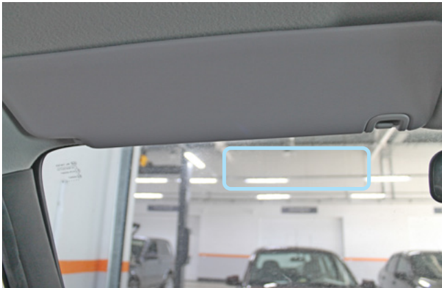
Фото 2.1. Возможное место установки антенного модуля
