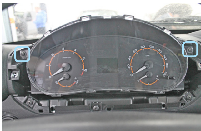
Фото 1.4. Саморезы крепления панели приборов
