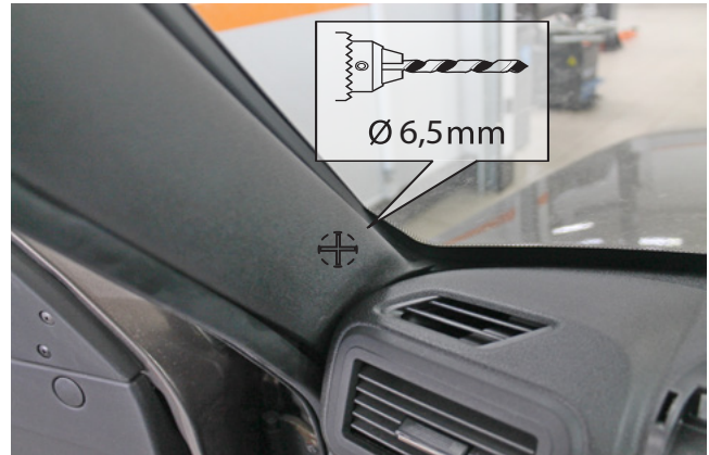
Фото 2.2. Место установки светодиода
