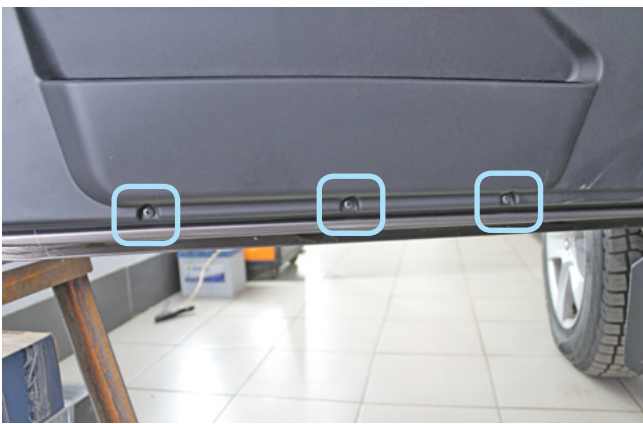
Фото 1.24. Саморезы крепления накладки двери снизу
