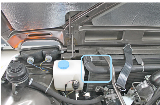
Фото 2.5. Место установки датчика температуры двигателя
