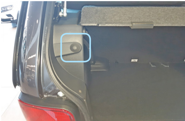
Фото 3.9. Местоположение концевика багажника
