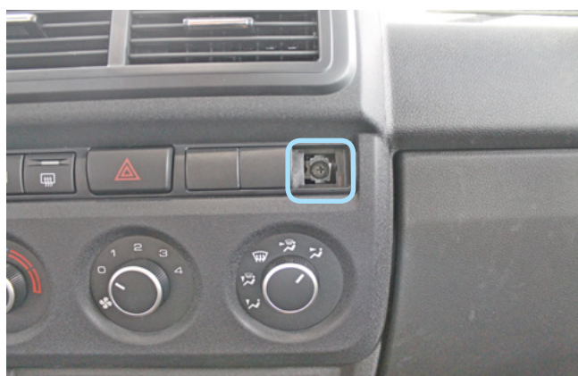
Фото 1.8. Декоративная заглушка снята. Саморез крепления
