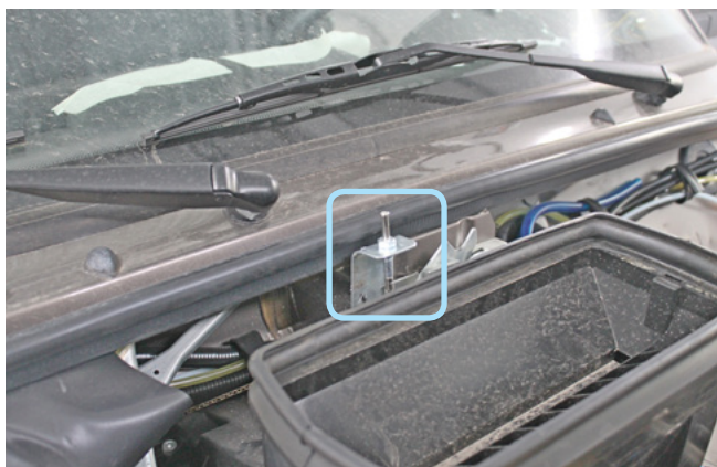
Фото 2.7. Возможное место установки концевика капота
