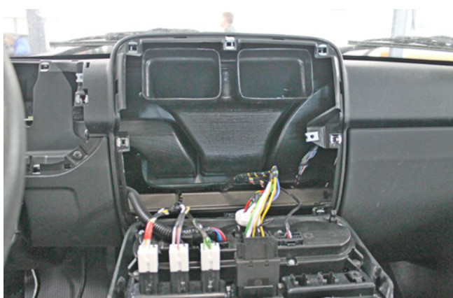
Фото 1.10. Блок управления отопителем снят
