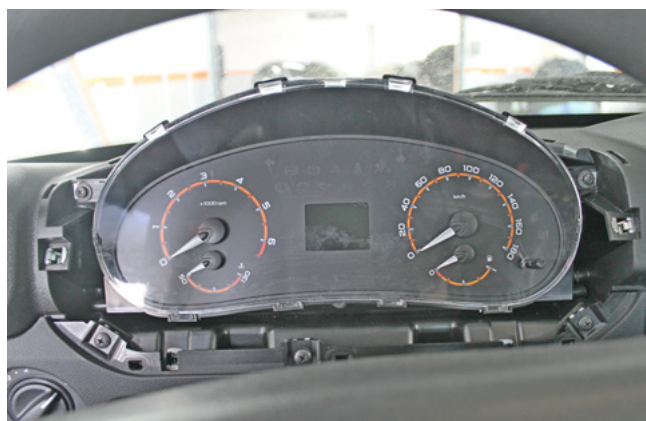
Фото 1.3. Декоративная накладка панели приборов снята
