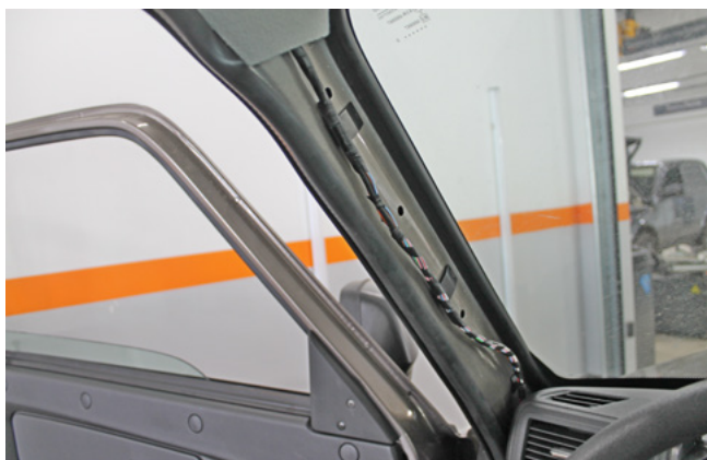
Фото 1.13. Левая боковая стойка снята
