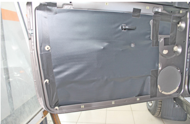
Фото 1.26. Пластиковая накладка двери снята
