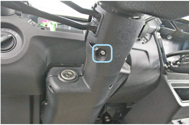
Фото 1.16. Саморез крепления нижней части кожуха
