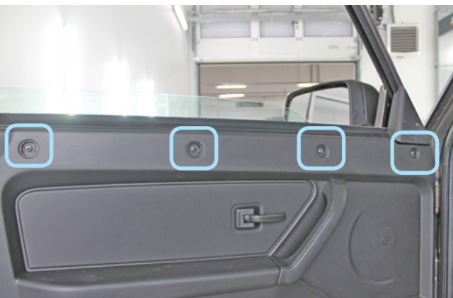
Фото 1.20. Заглушки сняты. Саморезы крепления
