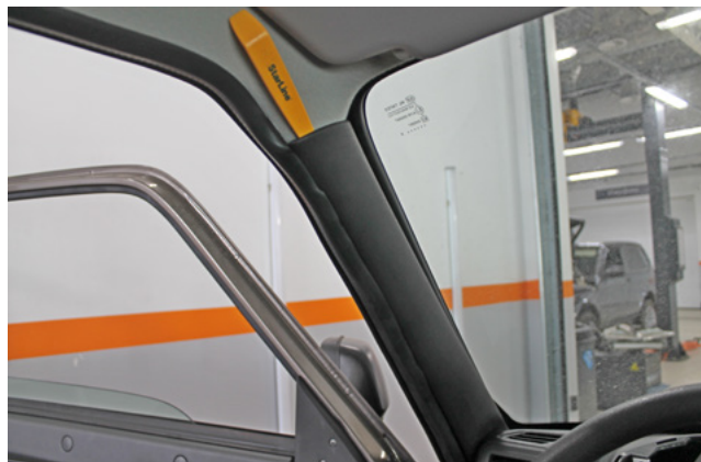
Фото 1.12. Снять левую боковую стойку
