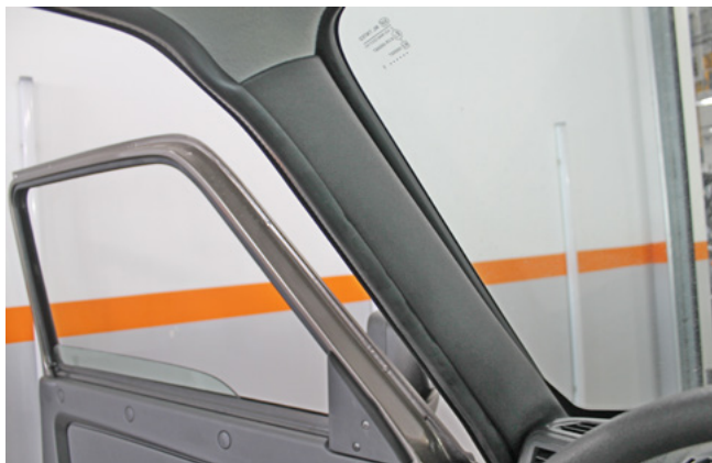
Фото 1.11. Левая боковая стойка. Общий вид
