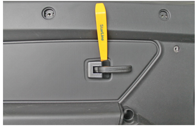
Фото 1.23. Снять декоративную накладку ручки отпирания двери
