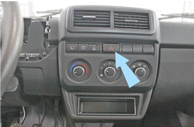
Фото 3.6. Местоположение кнопки аварийной сигнализации
