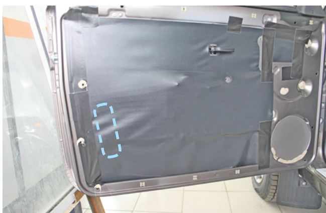
Фото 2.9. Возможное место установки электропривода двери
