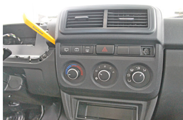
Фото 1.9. Снять блок управления отопителем
